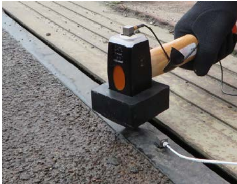
Het meten van de ingangsimpedantie van het brugdek op verschillende punten geeft inzicht in de mobiliteit en de benodigde maatregelen
