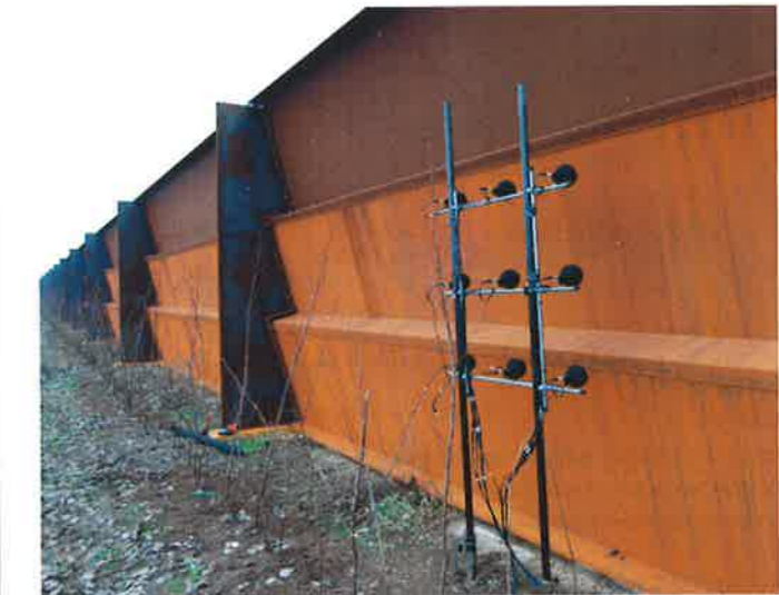
FIGUUR 2: IN SITU METEN VAN DE GELUIDISOLATIE. DE LINKER FOTO TOONT DE GELUIDBRON, DE RECHTER FOTO, TOONT HET MICROFOONARRAY ACHTER HET SCHERM
