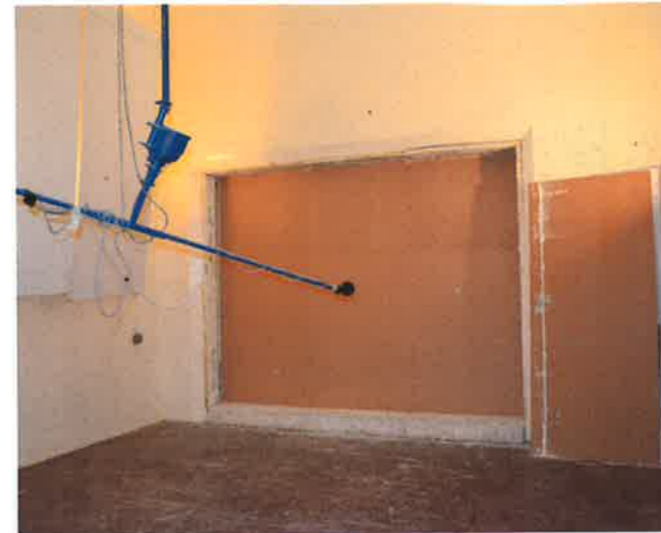
FIGUUR 1: BEPALING VAN DE AKOESTISCHE ISOLATIE EN ABSORPTIE IN HET LABORATORIUM
