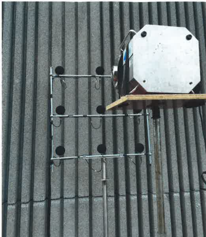
FIGUUR 3: IN SITU METEN VAN DE REFLECTIE INDEX. LINKS: METING AAN HET GELUIDSCHERM. RECHTS: REFERENTIEMETING
