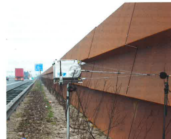
FIGUUR 2: IN SITU METEN VAN DE GELUIDISOLATIE. DE LINKER FOTO TOONT DE GELUIDBRON, DE RECHTER FOTO, TOONT HET MICROFOONARRAY ACHTER HET SCHERM
